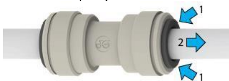
Figura 7. Desconectando os tubos
