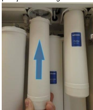
Figura 15. Instalação do pré-filtro.
