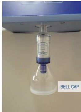
Figura 20. instalação do dispensador de filtro 0,22 \mu .
