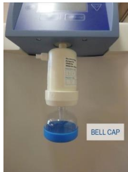
Figura 21. Instalação do dispensador Ultra filtro.
