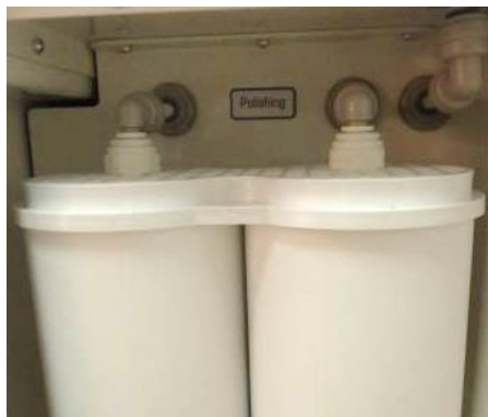
Figura 14. Encaixe do módulo dentro da unidade.
